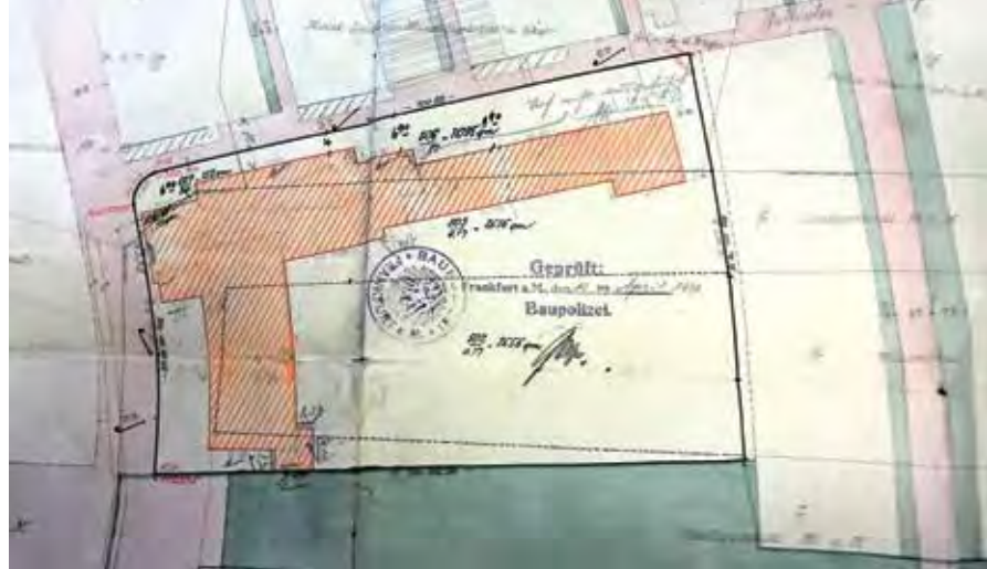
Plan des Hauses der Jugend aus dem Frühjahr 1929 mit der Skizze der ursprünglichen Planung. Mit Bleistift ist für einen Teil des rechten Flügels vermerkt: »wird nicht ausgeführt«
